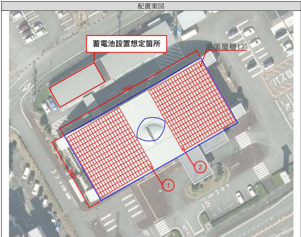
太陽光発電設備設置想定箇所
